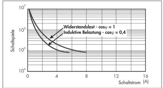
**H 41- Gleichstromschaltvermögen bei DC1 - Belastung**
