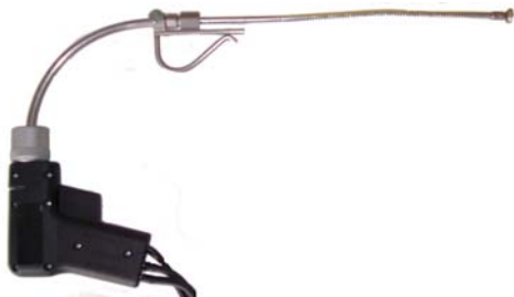
Gasentnahmesonde mit flexiblem Entnahmerohr
