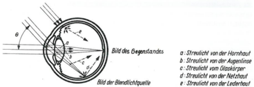
BILD 3: Im Augapfel durch Inhomogenitäten entstehendes Streulicht [1] FIGURE 3: Scattering light in the eye ball caused by inhomogeneities [1]
