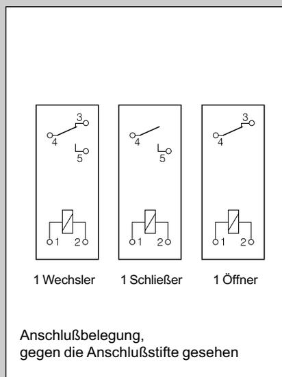
Gleichstrom-Kleinrelais der Serie AZ 693/2693 eignen sich wegen ihrer hohen Schaltleistung besonders für den Einsatz als Ausgangs- und Koppelrelais in der Steuerelektronik. Sie erfüllen die Anforderungen der Schutzklasse II für sichere elektrische Trennung (z.B. VDE 0631/0700).
